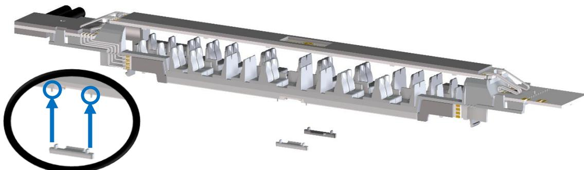
Anschließend werden die Kondensatoren um 90 Grad in ihre Einbauposition gebogen und die Drähte der unteren Leiterplatte sauber verlegt und zwischen den Pins fixiert.
